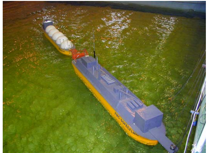
Figure 7 LNG tandem offloading model tests
